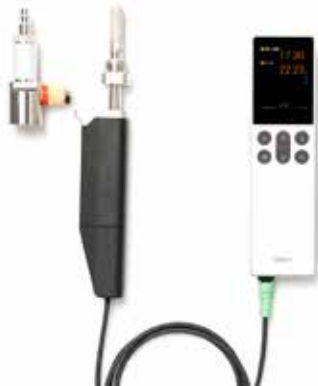
Indigo80 Messgerät, DMP80 Sonde, DSC74 Probenzelle mit Schnellanschluss
