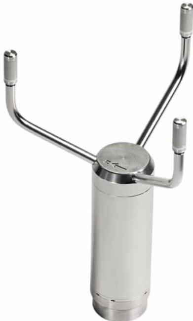
Ультразвуковой датчик ветра Vaisala WINDCAP® серии WMT700 не требует технического обслуживания, не имеет движущихся частей, а запатентованная проектная схема преобразователя с тремя элементами обеспечивает получение точных данных во всех направлениях ветра.
