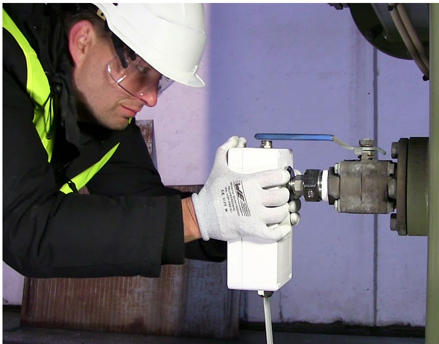
Vaisala vocht-, waterstof- en temperatuurtransmitter MHT410
