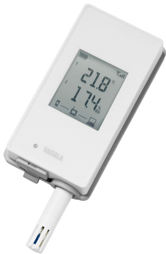
Data logger di temperatura e umidità wireless Vaisala VaiNet RFL100
