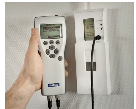
Étalonnage sur site d'un transmetteur d'humidité HMW90 avec un appareil portable de mesure de l'humidité et de la température HM70.
