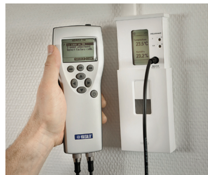
Vor-Ort-Kalibrierung eines Feuchtemesswertgebers HMW90 mit einem portablen Messgerät HM70.
