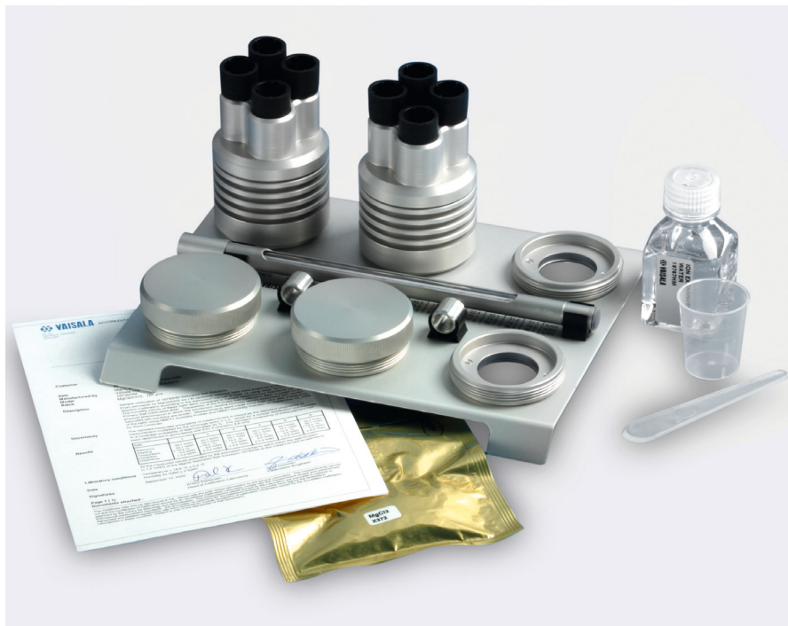
Vaisala Feuchtekalibrator HMK15 für Mehrpunktkalibrierungen vor Ort.
