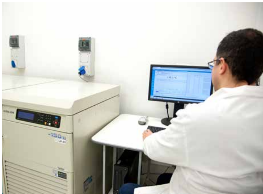
Motta 博士正在 viewLinc 弹出警报窗口中检查低温冷冻库的状态
