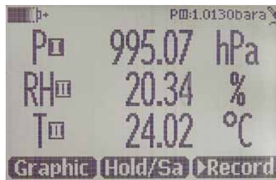
Algunos instrumentos de medición de la humedad permiten elegir un parámetro individual de humedad que puede ser observado en una pantalla. La figura muestra diferentes vistas de la pantalla del medidor portátil de humedad y temperatura Vaisala HUMICAP HM70.
