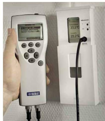
Calibración en sitio de un transmisor de humedad HMW90 con un medidor manual HM70.
