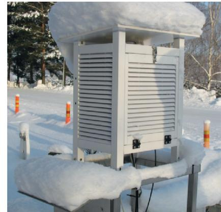
Figure 2 : 2 instruments HUMICAP® ont été installés dans un abri Stevenson sur la zone de test de Vaisala à Vantaa en Finlande. Purge de la sonde également utilisée.
